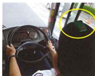
装置を取り付右左折時の確認動作などをデータで読み取る
