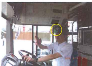
装置を取り付右左折時の確認動作などをデータで読み取る
